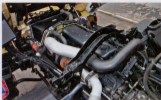
Под кабиной самосвала двигатель Cummins B объемом 8,7 литра, но его мощность – 250 лошадиных сил
