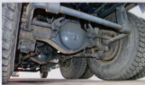
У самосвала IVECO 682 стальной дорожный просвет под задним мостом: не менее 350 миллиметров
