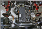
Под кабиной тягача двигатель Saurab в объеме 6,7 литра стандарта Евро-4, мощностью 390 лошадиных сил
